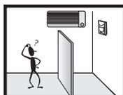
Não coloque o sensor olhando diretamente para ar condicionado ou local com circulação de ar.
